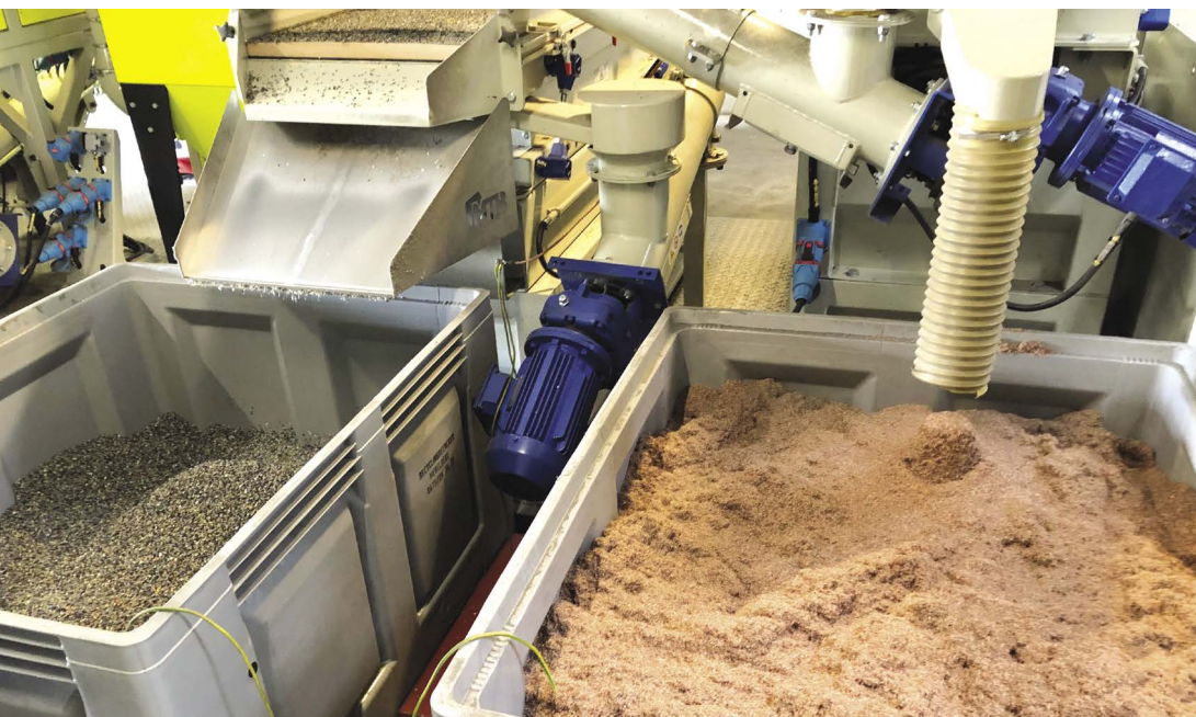
Plastique dans le conteneur de gauche ; cuivre pur dans le conteneur de droite
